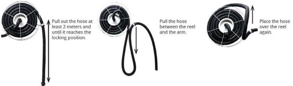
Die Federkraft der Schlauchtrommel ist so eingestellt, dass der Schlauch leicht über die gesamte Länge herausgezogen und aufgerollt werden kann.
